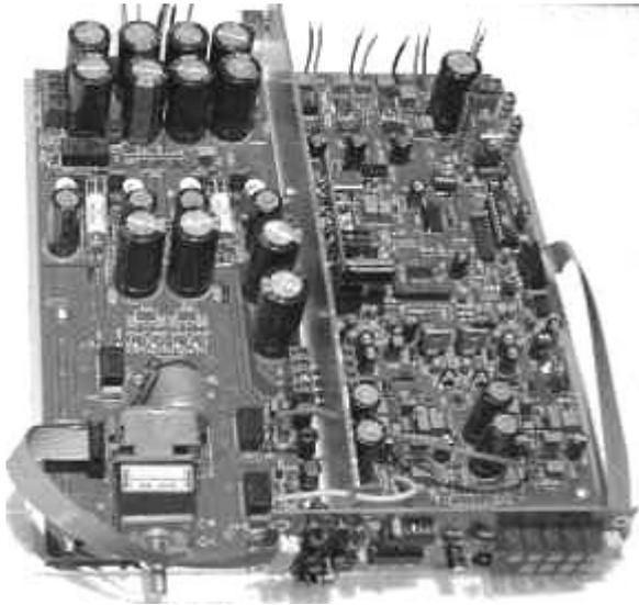
Eine Besonderheit ist der neue **Data-Link-Eingang (AC-DL)** der in Verbindung mit unserem neuen **CD-Laufwerk ORIGO** eingesetzt werden kann. Die Digitaldaten werden nicht wie im S/PDIF-Format kodiert übertragen, sondern getrennt in Systemtakt, Daten und Synchronisation (ähnlich I<sup>2</sup>S). Dies ermöglicht weitere Jitterreduzierung und Klangverbesserung.
