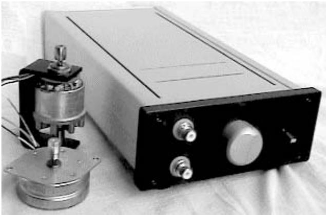
Unser QPS (Quarz-Power-Supply) ist ein Präzisions-Motornetzteil für Synchronmotoren. Es wurde entwickelt für den Einsatz an hochwertigen Analoglaufwerken.
